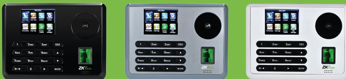
P160 es una terminal multi-biométrica para aplicaciones de Tiempo y Asistencia con funciones de Control de Acceso ya que puede ser conectada con cerraduras eléctricas, sensores de puertas y botones de salidas.
