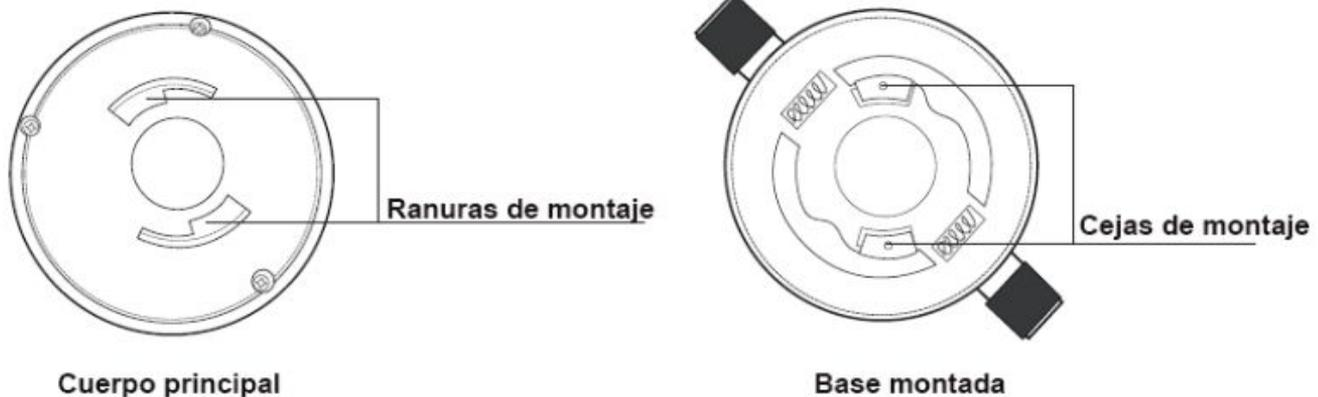
2. Conecte la línea de energía eléctrica a las terminales de conexión de la parte inferior del transmisor, luego fíjelo verticalmente en el hoyo para finalizar su instalación
