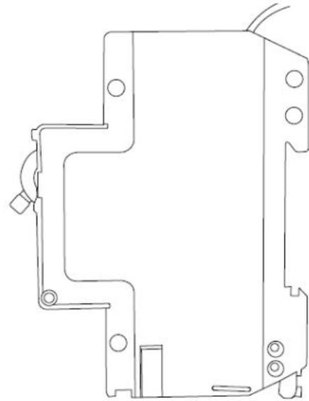
2. Instale el producto sobre el riel, y después presione el sujetador del riel para que pueda fijarse en su lugar correctamente el dispositivo sobre el riel (Cuándo la posición es Off).
