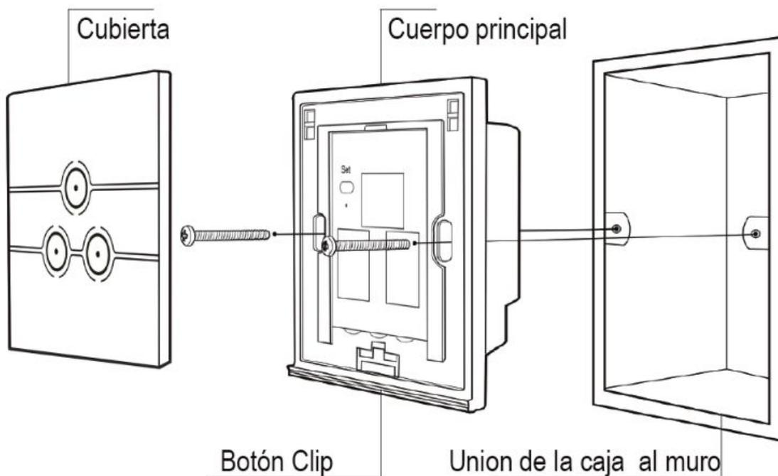
3. Coloque la cubierta sobre el cuerpo principal y la instalación estará completada, como se muestra en la siguiente imagen, conéctese a la red antes de completar la instalación Switch Touch (tipo 03)
