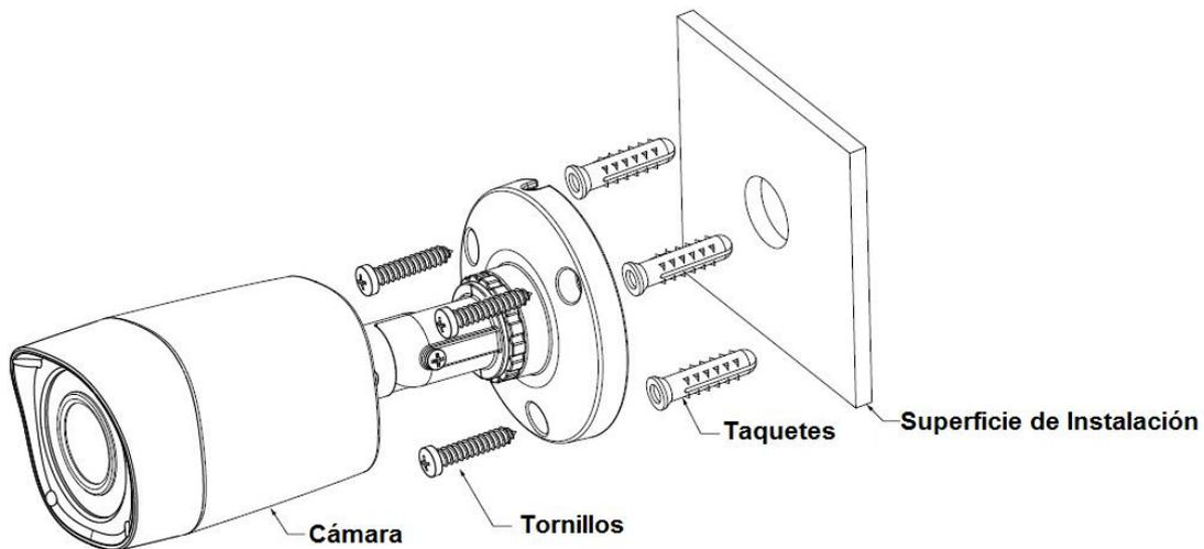
Una vez fijada a la pared proceda a enfocarla, esto se realiza ajustando los tornillos de bloqueo.
