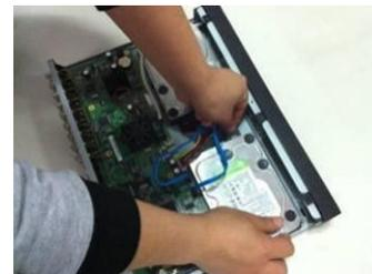
⑥ Conecte el cable HDD y el cable de alimentación.
