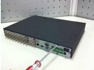
① Afloje los tornillos de la cubierta superior y el panel lateral.
