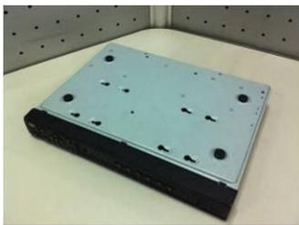
④ Coloque el dispositivo boca abajo y luego gire los tornillos con firmeza.
