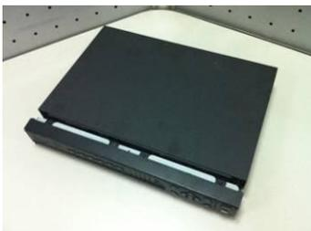
⑦ Coloque la cubierta de acuerdo con el clip y luego coloque la cubierta superior hacia atrás.
