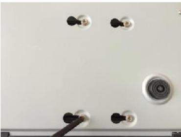
4. Gire el dispositivo para ver la parte posterior de la misma. Dirija los tornillos de la unidad de disco duro a los orificios de la parte posterior del dispositivo y luego fije los tornillos.
