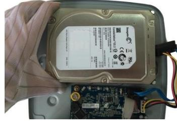
3. Haga coincidir los tornillos con los orificios del DVR para colocar el disco duro.
