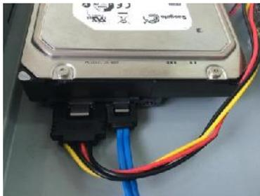
5. Utilice el cable de la unidad de disco duro y el cable de alimentación para conectar la unidad de disco duro y la placa base.
