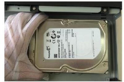
3. Coloque el disco duro en el dispositivo.
