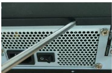
1. Retire los tornillos de la cubierta.
