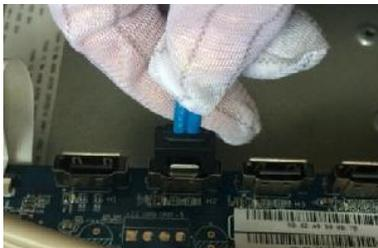
4. Conecte el otro extremo del cable HDD a la placa base
