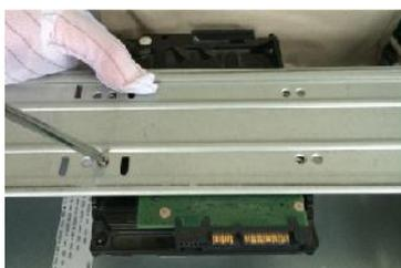
2. Use los tornillos para fijar el HDD en el soporte.
