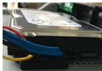
5. Utilice el cable de la unidad de disco duro y el cable de alimentación para conectar la unidad de disco duro y la placa base.
