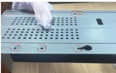
4. Haga coincidir los orificios del soporte con los orificios de los tornillos en el disco duro.
