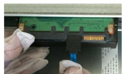
3. Conecte un extremo del cable de la unidad de disco duro a la unidad de disco duro.
