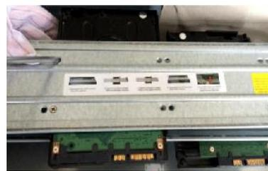
2. Fije los HDD en el soporte. Retire el soporte superior si desea instalar HDD en el soporte inferior.
