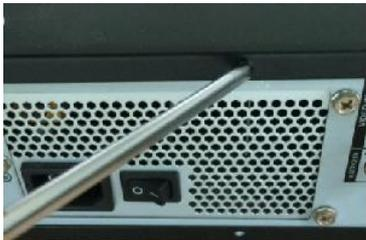
1. Afloje los tornillos del panel y retire la cubierta.
