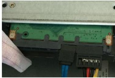
5. Utilice el cable de alimentación para conectar la unidad de disco duro y la placa base.
