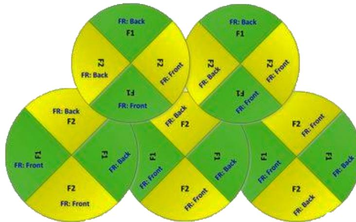
Para ver ejemplos de cómo configurar la reutilización de frecuencia para garantizar que se reduzca la interferencia durante todo el despliegue, consulte la figura a la derecha.
